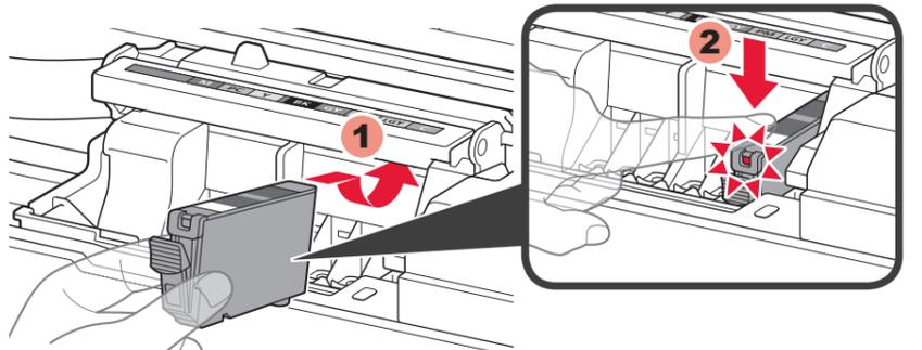
3 将墨水盒插入并向下推动至匹配颜色插槽。
