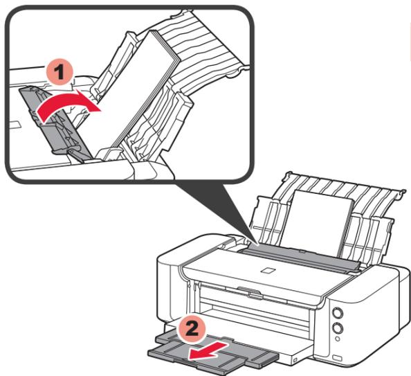
4 关闭进纸插槽盖板，然后拉出出纸托盘扩展架。
