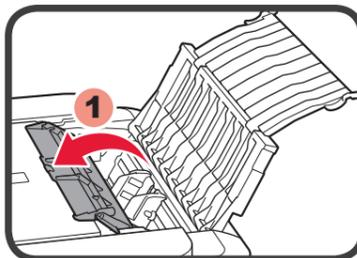
2 打开进纸插槽盖板，然后移动纸张导片到两侧。
