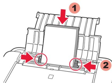
3 以打印面向上装入纸张，然后调整纸张导片以适合纸张宽度。
